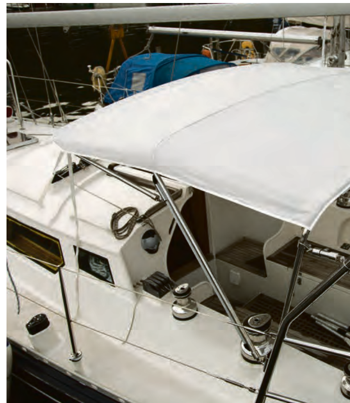
Es ist weiterhin möglich ein Bimini direkt am Geräteträger anzuschlagen. It is still possible to attach a bimini directly to the carrier.
